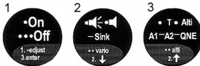
**Beginnen:** -Schalter 3 drücken und gedrückt halten und währenddessen das Gerät einschalten. Das Display zeigt ein (d) oder ein (b) an - (d = Drachen-Gleitschirmmodus, b = Ballonmodus)
